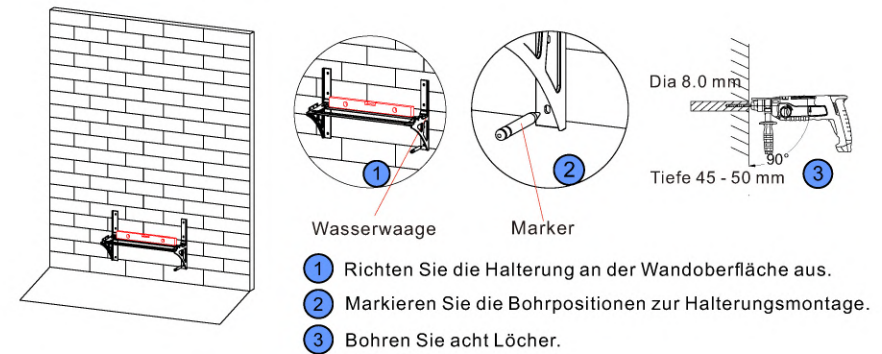
Abbildung 4-9: Bestimmung der Bohrpositionen für die Wandhalterung
