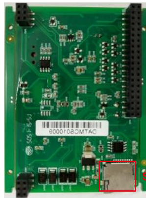
Micro-SD-Einschub der 22-kW-Ladestation
