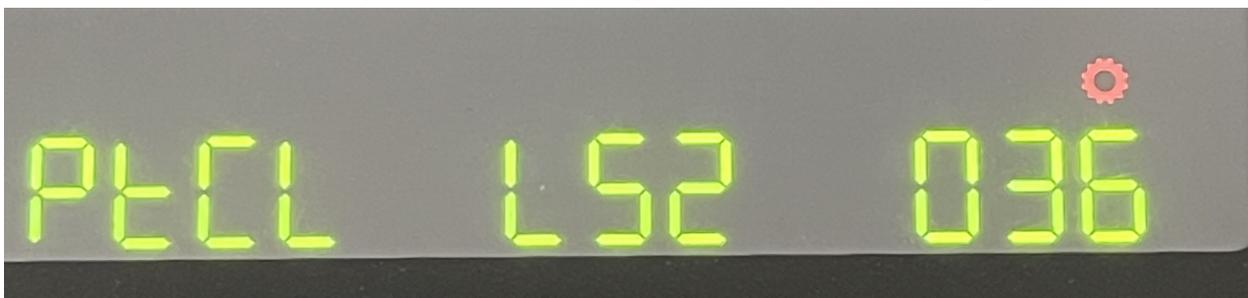
8. Nachdem Sie ein Protokoll gefunden haben was funktioniert, gehen Sie ins Startmenü des SPF zurück. Nun sollte der Wechselrichter mit den Pylontechbatterien kommunizieren.
