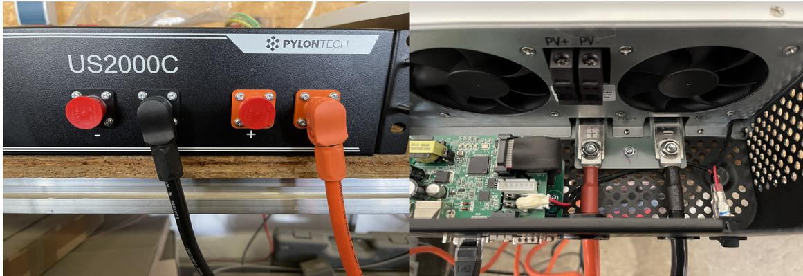
2. Als nächstes müssen Sie nun das bei der Pylontech beiliegende Inverterkabel in den A/Can Anschluss der Batterie stecken.
