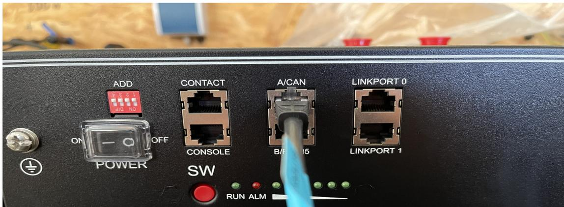
3. Das Inverterkabel wird nun in den BMS Anschluss des SPF gesteckt.
