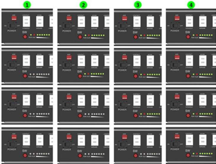
**Leuchten alle Batterie-LEDs auf und gehen dann wieder aus, so bedeutet dies, dass das Batteriesystem in Ordnung ist und funktioniert.**
