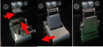
Die vier Führungsstifte und Aufnahmebohrungen übereinander anordnen und die Batterien übereinanderstapeln. Anschließend mit den vier Klammern verriegeln.
