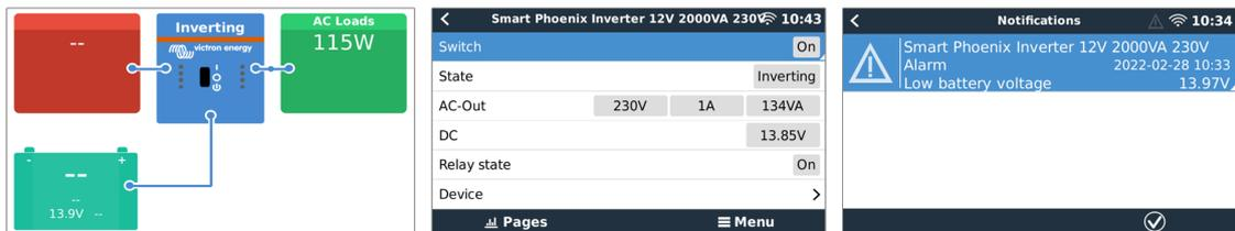
*Beispiel für die Anzeigen des GX von links nach rechts: Systemanzeige, Anzeige des Wechselrichters und eine Alarmmeldung.*
