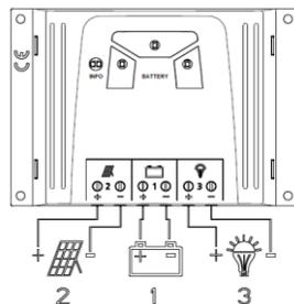
Unbedingt die unten beschriebene Anschlussreihenfolge einhalten. Benutzen Sie für alle Klemmverbindungen einen Drahtschutz oder Aderendhülsen.
