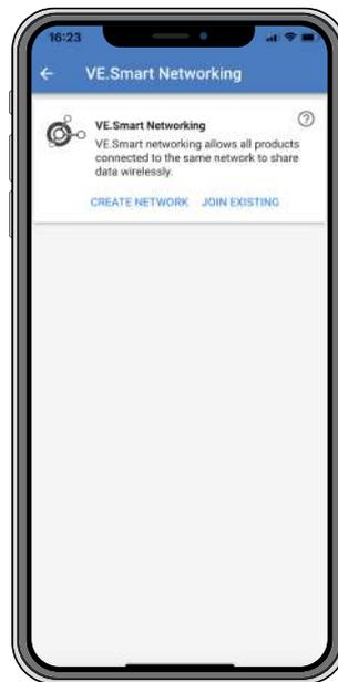
Mit dem VE.Smart-Networking können verschiedene Produkte, die an dasselbe Netzwerk angeschlossen sind, Daten über Bluetooth austauschen. Es wurde speziell für kleinere Systeme entwickelt, in denen kein GX-Gerät installiert ist.
