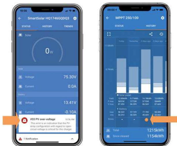
Ein aktiver Fehler und ein historischer Fehler.
