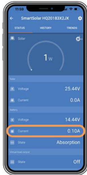
Die VictronConnect-App zeigt einen Ladestrom von beinahe Null an.
