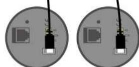
Es können bis zu vier BMVs direkt mit einem Color Control verbunden werden. Es lassen sich sogar noch mehr BMVs an einen USB-Hub anschließen, um zentral überwacht zu werden.
