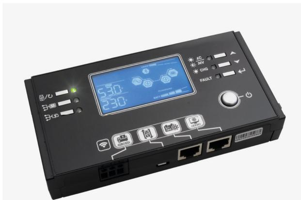
Abnehmbares Bedienpanel inkl. LCD-Display
