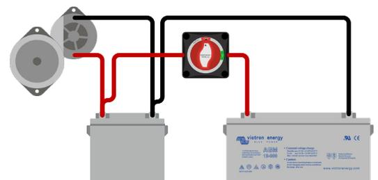
Der Batterieschalter wird als paralleler Notschalter verwendet.
