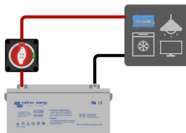
Mit dem Batterieschalter kann eine Batterie von einem Gleichstromsystem getrennt werden.
