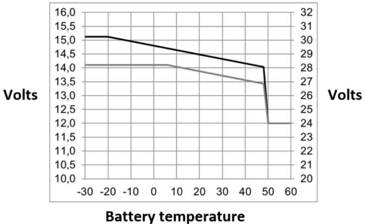
Die standardmäßigen Ausgangsspannungen für den Ladeerhaltungs- und Konstantspannungsmodus gelten bei 25 °C. Reduzierte Ladeerhaltungsspannung folgt auf Ladeerhaltungsspannung und Erhöhte Konstantspannung folgt auf Konstantspannung. Im Anpassungsmodus gilt die Temperaturkompensation nicht.
