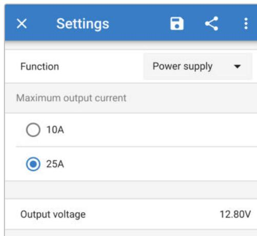
Es ist auch möglich, den Niedrigstrommodus im Stromversorgungsmodus zu aktivieren und die gewünschte Ausgangsspannung zu spezifizieren.
