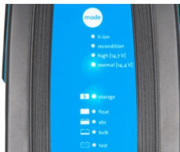
4. Falls erforderlich, aktivieren Sie den Schwachstrommodus (reduzierter Ladestrom); drücken und halten Sie die MODE-Taste 6 Sekunden lang, wenn aktiviert, blinkt die LED des gewählten Lademodus (normal / hoch / Li-Ion). Drücken und halten Sie die MODE-Taste erneut 6 Sekunden lang, um den Schwachstrommodus zu beenden.
