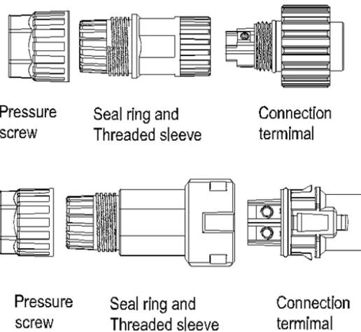
2. Führen Sie das abisolierte Kabel durch die Druckschraube (Pressure Screw), den Dichtring (Seal Ring) und die Gewindebuchse (Threaded Sleeve). Danach führen Sie das Kabel der Polarität entsprechend in die Anschlüsse ein und verschließen die Schraubverschlüsse fest. Ziehen Sie am Kabel, um zu überprüfen, ob es tatsächlich festsitzt.
