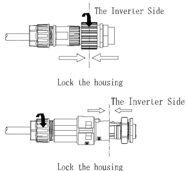
5. Um den AC-Anschluss zu entfernen, drücken Sie den Bajonettverschluss mithilfe eines kleinen Schraubendrehers aus der Fassung und ziehen Sie die Anschlüsse auseinander. Oder schrauben Sie die Gewindebuchse auf.
