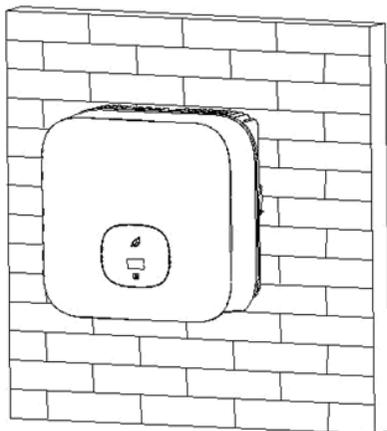
Nachdem überprüft wurde, dass der Wechselrichter festhängt, sichern Sie ihn mit den M6-Sicherheitschrauben auf der rechten und linken Seite, damit er nicht aus der Halterung gehoben werden kann.
