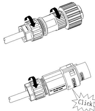
4. Zum Abschluss schieben oder schrauben Sie die Gewindebuchse auf den Anschluss bis beides fest mit dem Wechselrichter verbunden ist.
