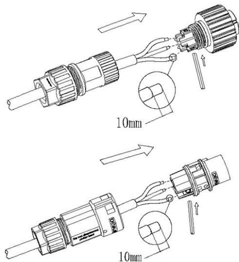
3. Schieben Sie die Gewindebuchse in die Fassung und verschrauben Sie die Kappe mit dem Anschluss.
