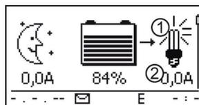
Abb. 16 Display-Inhalt nach dem Einschalten des Lastausgangs
