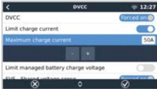
„Ladestrom begrenzen“ ist eine vom Benutzer konfigurierbare maximale Ladestromeinstellung. Es funktioniert über das gesamte System, wobei die Solaranlage zuerst Priorität hat, dann das Orion XS DC-DC-Batterieladegerät und dann der Wechselrichter/Ladegerät.
