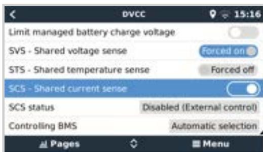
Diese Eigenschaft leitet den von einem an das GX-Gerät angeschlossenen Batteriemonitor gemessenen Strom der Batterie an alle angeschlossenen Solarladegeräte und Orion XS DC-DC-Batterieladegeräte weiter.
