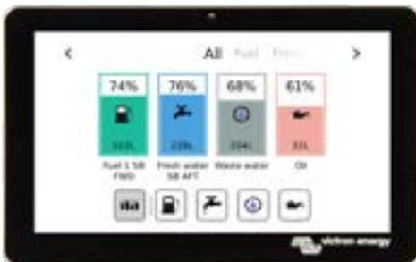
Der GX Tank 140 ist sowohl mit Stromsendern (4 bis 20 mA) als auch mit Spannungssendern (0 bis 10 V) kompatibel. Das GX-Gerät wird über USB verbunden, wodurch der GX Tank auch mit Strom versorgt wird. Es sind keine zusätzlichen Stromkabel erforderlich.
