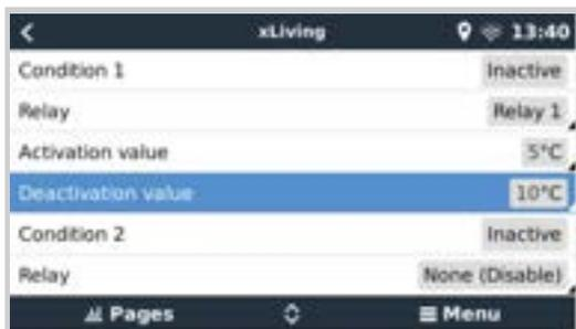
Sollte dies nicht ausreichen, um die Temperatur der Batterie über 5 Grad zu halten, können Sie auch ein zweites Heizkissenschütz an Relais 2 anschließen.
