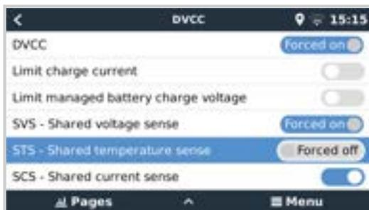
Wählen Sie den zu verwendenden Temperatursensor aus; und das GX-Gerät sendet die gemessene Batterietemperatur an das Inverter/Ladegerätsystem sowie an alle angeschlossenen Solarladegeräte und Orion XS DC-DC-Batterieladegeräte.
