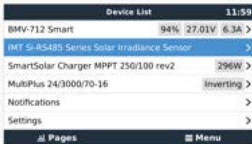
Innerhalb des Menüs „IMT Sonneneinstrahlungssensor der Serie Si-RS485“ werden alle verfügbaren Parameter automatisch angezeigt (abhängig von den angeschlossenen Sensoren) und in Echtzeit aktualisiert.
