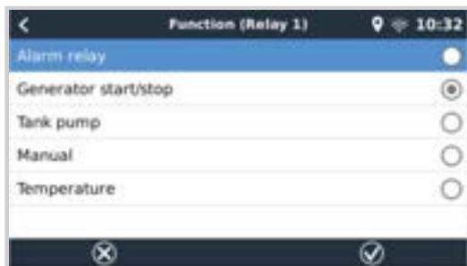
Nachdem Sie diese Funktion aktiviert haben, finden Sie alle Einstellungen, die mit der Funktion Automatischer Generator-Start/Stop zusammenhängen, im Hauptmenü unter: Einstellungen → Generator Start/Stop.
