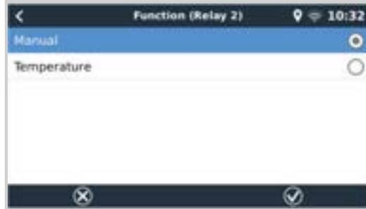
Wenn die Relaisfunktion als Alarm-Relais konfiguriert ist, ist es möglich, die Polarität des Relais über ein zusätzliches Menü umzupolen. Die Standardeinstellung ist Normalerweise offen. Bitte beachten Sie, dass die Umkehrung der Polarität auf Normalerweise geschlossen zu einem etwas höheren Stromverbrauch des GX-Geräts führt.
