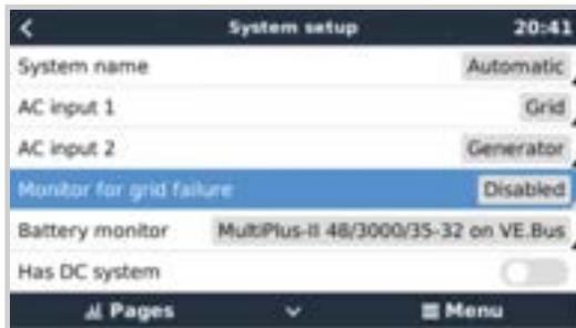
Wenn diese Funktion aktiviert ist, wird ein Alarm ausgelöst, wenn das System länger als 5 Sekunden nicht an den als Netz oder Land konfigurierten AC-Eingang angeschlossen wurde.
