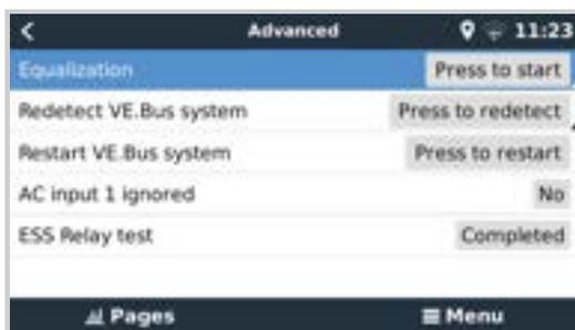
Das Menü Erweitert kann über Geräteliste → [Multi oder Quattro] → Erweitert aufgerufen werden und enthält Optionen für den Abgleich, die Neuerkennung und den Neustart des VE.Bus-Systems und zeigt den Status der Prüfung des ESS-Relais an.
