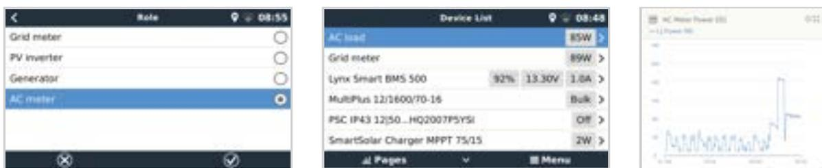
Allen [Typen von Energiezählern](#) kann die Funktion Wechselstromzähler zugewiesen werden. Dies geschieht über das Menü Einstellungen → Energiezähler → [Ihr\_Energiezähler] → Rolle, wo Sie zwischen Netz, PV-Wechselrichter, Generator und Wechselstromzähler wählen können. Wenn Wechselstromzähler ausgewählt ist, wird die Last in der Geräteliste und im VRM in den erweiterten Widgets angezeigt.
