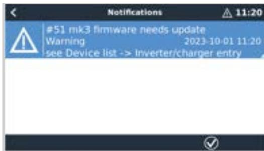
Wenn diese Benachrichtigung angezeigt wird, wird empfohlen, den in das GX-Gerät eingebauten MK3-Regler zu aktualisieren. Diese Aktualisierung ist für die neuesten Funktionen erforderlich, einschließlich der Aufwärm- und Abkühlungszeiten zum Starten/Stoppen des Generators.
