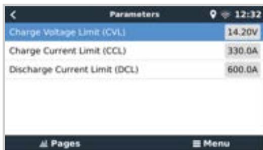
Dieses Kapitel gilt für alle Systeme, in denen ein intelligentes Batterie-BMS installiert und über den CAN-bus angeschlossen ist. Beachten Sie, dass dies nicht das Victron VE.Bus BMS umfasst.
