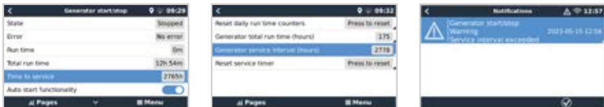
Jeder Generator muss nach einer bestimmten Zeit gewartet werden. Die empfohlene Wartungsfrequenz eines Generators hängt insbesondere von seiner Verwendung und Betriebsdauer ab. Dieses Zeitintervall kann über dieses Menü eingestellt werden, das dann einen Zähler startet, der bei Ablauf des Intervalls eine Warnung über die notwendige Wartung ausgibt.
