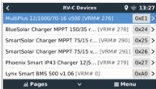
Wenn Sie das Untermenü eines RV-C-Gerätes aufrufen, werden Ihnen allgemeine RV-C-Geräteinformationen angezeigt und vor allem das Konfigurationsmenü, wenn Sie bis zum Ende der Seite nach unten scrollen. Die Anzeige des Konfigurationsmenüs erfordert mindestens eine Zugangsebene für Benutzer und Installateure, siehe Kapitel [Menüstruktur und konfigurierbare Parameter](#) [52].
