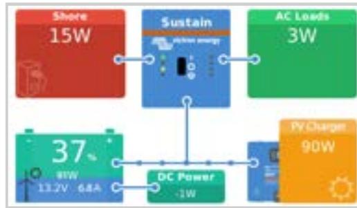
Die Solar- und Windprioritätsfunktion sorgt dafür, dass Solarenergie und Windenergie zum Laden der Batterie genutzt werden. Gleichzeitig wird der Landstrom nur genutzt, um zu verhindern, dass die Batterie zu tief entladen wird.
