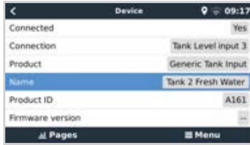
Für jeden Tanksensor kann ein separater Alarm für niedrigen oder hohen Füllstand eingestellt und aktiviert werden.
