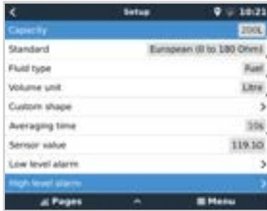
Sensoren werden im E/A-Menü der GX-Geräteeinstellungen (Einstellungen → E/A → Analoger Eingang) aktiviert (und deaktiviert). Sobald der Tank aktiviert ist, erscheint er in der Geräteliste mit Optionen, mit denen Sie die Einrichtung an Ihre spezielle Installation anpassen können.
