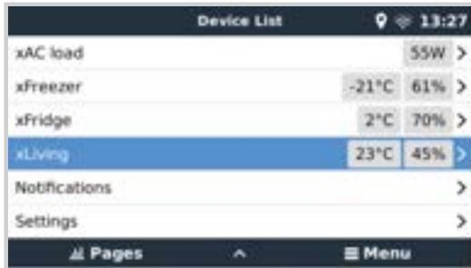
Das Temperaturrelais wird über das Menü Einstellungen → Relais → Funktion (Relais 1/2) → Temperatur gesteuert. Sobald es aktiviert ist, erscheint das Menü Temperatursteuerung Regeln im Menü Relais und innerhalb der erkannten Temperatursensoren.
