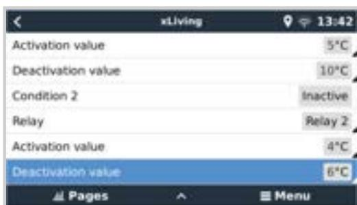
Das bedeutet, dass das Relais 1 aktiv wird, wenn die Temperatur der Batterie auf 5 Grad fällt. Wenn die Temperatur weiterhin unter 5 Grad bis 4 Grad fällt, wird das zweite Heizkissen über Relais 2 aktiviert. Sollte dadurch die Temperatur wieder auf 6 Grad ansteigen, wird Relais 2 deaktiviert und Relais 1 bleibt aktiv, bis die Temperatur der Batterie wieder 10 Grad erreicht hat.
