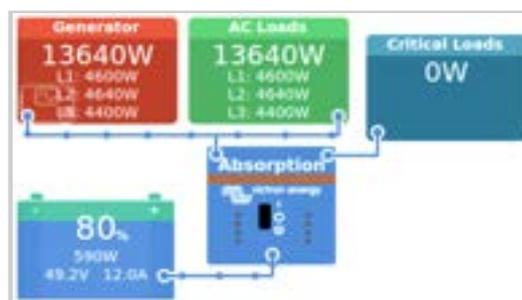
Durch die Einbindung des ComAp IntelliLite 4 Generatorreglers in ein GX-Gerät können Wechselstromdaten, Öldruck, Kühlmitteltemperatur, Tankfüllstand und weitere Statuswerte ausgelesen werden. Darüber hinaus unterstützt es die digitalen Start/Stop-Signale des GX-Geräts.
