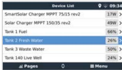
Stellen Sie die Tankvolumeneinheit (Kubikmeter, Liter, Imperial oder U.S.-Gallone) und die Kapazität ein. Es ist auch möglich, benutzerdefinierte Formen für nicht-lineare Tanks zu konfigurieren, mit bis zu 10 Variationen, z.B. 50 % des Sensors entspricht 25 % des Volumens & 75 % des Sensors entspricht 90 % des Volumens.
