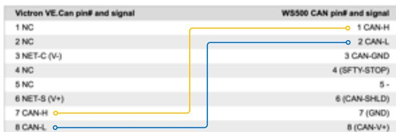
Die wichtigsten Pins sind Pin 7 und Pin 8 für CAN-H und CAN-L auf der VE.Can-Seite und Pin 1 und 2 für CAN-H und CAN-L auf der WS500-Seite.
