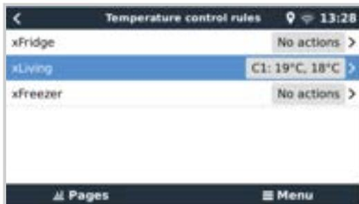
Bei GX-Produkten, die über zwei Relais verfügen (Cerbo GX & Cerbo-S GX, Ekran GX), kann ein einziger Temperatursensor beide Relais steuern. Ein einziges Relais kann auch von mehreren verschiedenen Temperatursensoren gesteuert werden. Zum Beispiel ein Cerbo GX mit 2 Lithium-Batterie-Heizkissen, wobei Sie beide nur bei Bedarf gleichzeitig verwenden.
