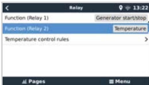
Jeder Temperatursensor kann zur Steuerung des Relais verwendet werden. Wählen Sie den Temperatursensor, den Sie zur Steuerung des Relais verwenden möchten. Die nicht verwendeten Temperatursensoren zeigen „Keine Aktionen“ an. In diesem Menü können Sie die Steuerung des Temperaturrelais für jeden Temperatursensor aktivieren oder deaktivieren.
