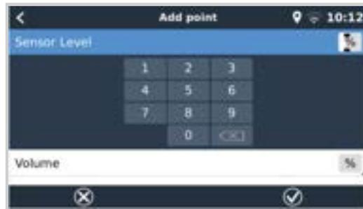
Die Tankfüllstandsanschlüsse können jeweils so konfiguriert werden, dass sie entweder mit europäischen (0 - 180 Ohm) oder US-amerikanischen Tanksendern (240 - 30 Ohm) arbeiten oder einen kundenspezifischen Ohm-Widerstandsbereich zwischen 0 Ohm und 300 Ohm konfigurieren (erfordert Firmware v2.80 oder höher).
