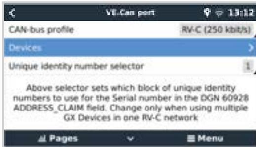
RV-C-Ausgangsgeräte können über das Untermenü Geräte im Menü des VE.Can-Anschlusses konfiguriert werden.
