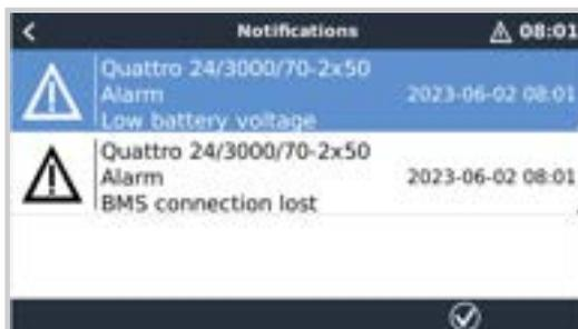
Diese Warnmeldung wird ausgelöst, sobald der Wechselrichter/das Ladegerät CVL/CCL- oder DCL-Daten von einer gemanagten Batterie empfangen hat, und schaltet sich ab, wenn die Batterie abgeklemmt wird oder die Kommunikation mit der Batterie verloren geht. Darüber hinaus wird die Warnmeldung ausgelöst, wenn der Wechselrichter/das Ladegerät die Verbindung zu einem VE.Bus-BMS verloren hat.
