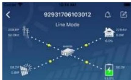
[Line-Modus] Der Wechselrichter versorgt die Last über das Netz mit oder ohne PV-Quelle. Das Netz oder eine PV-Quelle kann die Batterie im Standby-Modus aufladen.
