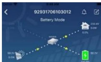
[Batteriemodus] Der Wechselrichter versorgt die Last aus der Batterie mit oder ohne PV-Quelle. Nur eine PV-Quelle kann die Batterie aufladen.
