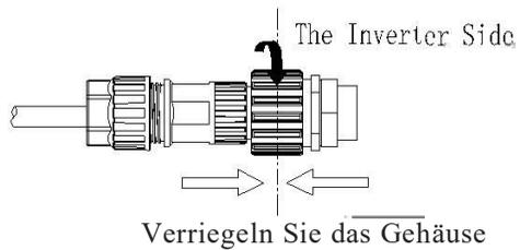
5. Um den AC-Stecker zu entfernen, drücken Sie das Bajonett mit einem kleinen Schraubendreher aus dem Schlitz und ziehen Sie es heraus, oder schrauben Sie die Gewindehülse ab und ziehen Sie sie heraus.
