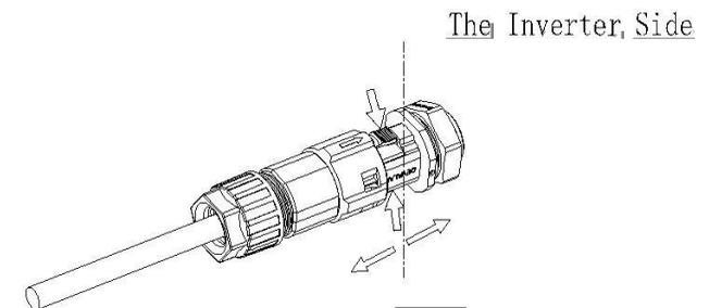
Schritt 2 Nutzen Sie das H-förmige Werkzeug und lösen Sie den Stecker aus der Fassung
