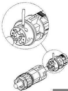
Schritt 3 Schieben Sie die Gewindebuchse zum Anschluss bis beide fest mit dem Wechselrichter verbunden sind.
