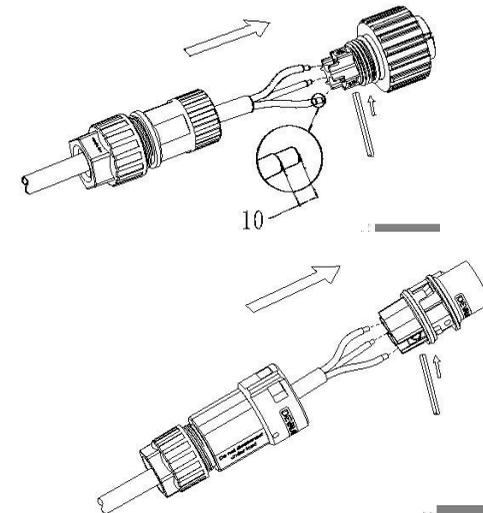
3. Schieben Sie die Gewindehülse in die Buchse, ziehen Sie die Kappe auf dem Terminal fest.
