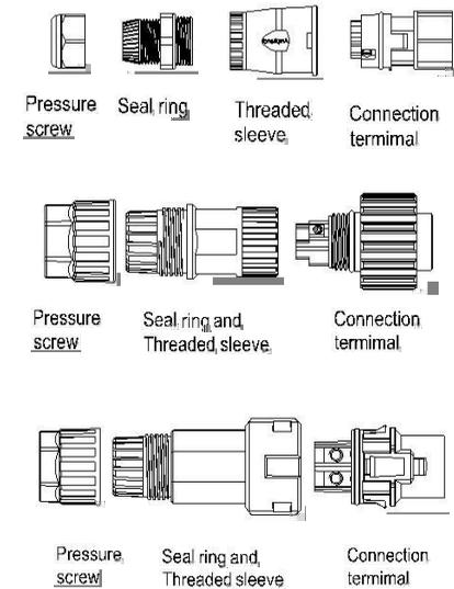
2. Führen Sie das abisolierte Kabel nacheinander durch Druckschraube, Dichtungsring und Gewindhülse ein, führen Sie die Kabel entsprechend der darauf angegebenen Polaritäten in den Anschlussterminal ein und ziehen Sie die Schrauben fest an. Bitte versuchen Sie, das Kabel herauszuziehen, um sicherzustellen, dass es gut angeschlossen ist.
