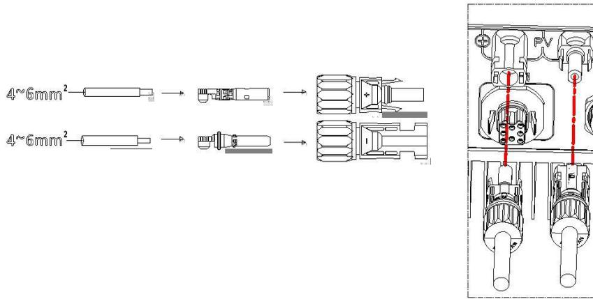
Schritt 2 Schieben Sie die Gewindebuchse auf die Fassung und verschrauben Sie die Kappe des Anschlusses.
