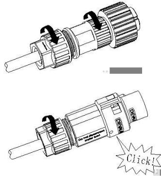
4. Zum Schluss schieben oder schrauben Sie die Gewindehülse auf die Anschlussklemme, bis beide fest auf dem Wechselrichter verriegelt sind.
